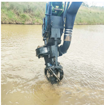
Watermaster производит дноуглубительные работы в хвостохранилище с помощью погружного режущего землессоса (производительность до 900 м³/ч)
