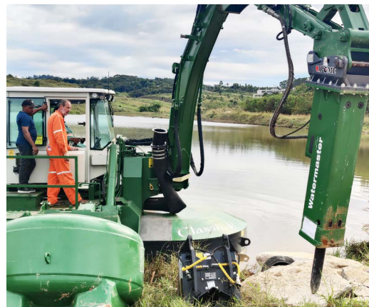
Камни в реке могут блокировать проход. Watermaster разбивает их гидромолотом, чтобы расчистить путь
