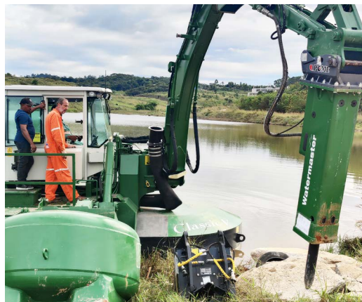
Las piedras en el río pueden bloquear el acceso. Watermaster las rompe con su martillo hidráulico para abrir el camino.
