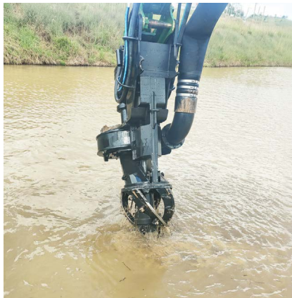
La Watermaster drague les résidus miniers à l'aide de sa pompe CUTTER submersible (jusqu'à 900 m 3 /h)
