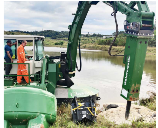
Les pierres dans la rivière peuvent bloquer le passage. La Watermaster les concasse à l'aide de son marteau hydraulique pour ouvrir la voie
