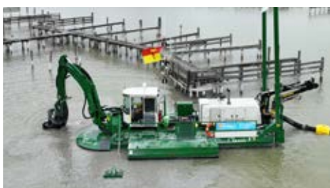
За первый сезон дноуглубления было вынута более 60 000 м 3 рыхлого осадка.
