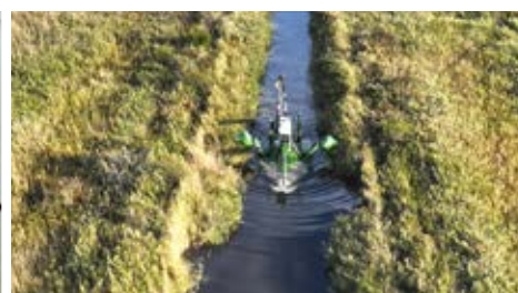
Земснаряд Watermaster также укрепил каналы из тростника, чтобы стабилизировать береговую линию и улучшить среду обитания диких животных.
