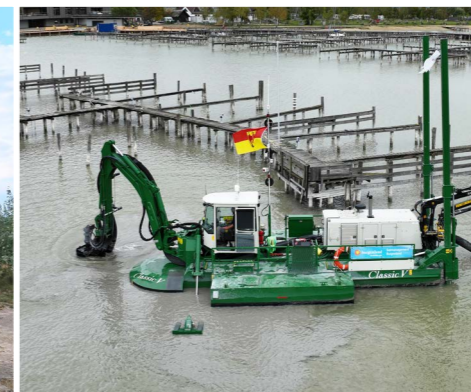
在第一个维护季，疏浚了超过 60000 米 3 的软质沉积物。
