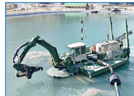
在有内衬的水库，“水王”能在不损坏水底的情况下，安全准确地作业
