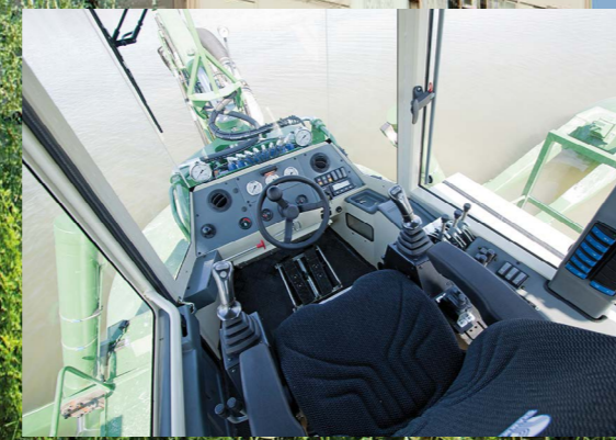
cabine certifiée FOPS (structure de protection contre les chutes d'objet)
