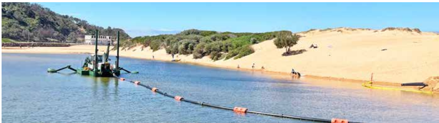
Protéger la communauté locale des inondations de manière intelligente Les dragues Watermaster pompent le sable accumulé directement sur le rivage et en une seule fois.
