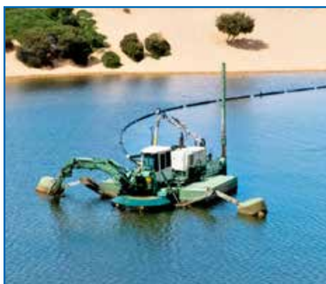
Les Watermasters draguent par aspiration le sable accumulé directement sur le rivage.
