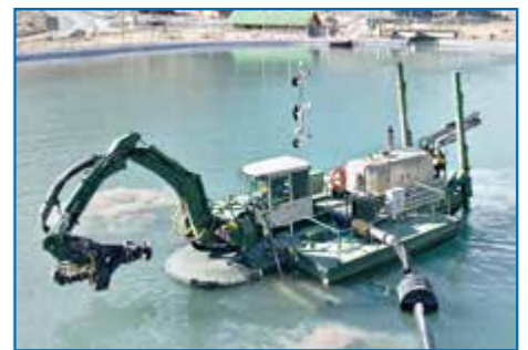
Watermaster fonctionne en toute sécurité et avec précision sans endommager le fond des réservoirs munis d'un revêtement.
