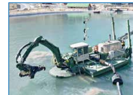
Watermaster opera en forma segura y precisa en embalses revestidos sin dañar el fondo
