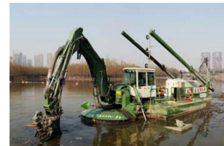
*Extracción de lodo mediante dragado por succión*
