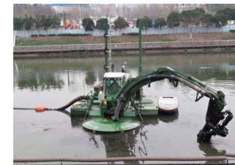
**Watermaster es una draga ambiental** funciona de manera extremadamente eficiente y exacta, con la capacidad de eliminar capas muy precisas de sedimentos y sin causar una gran cantidad de turbiedad.
