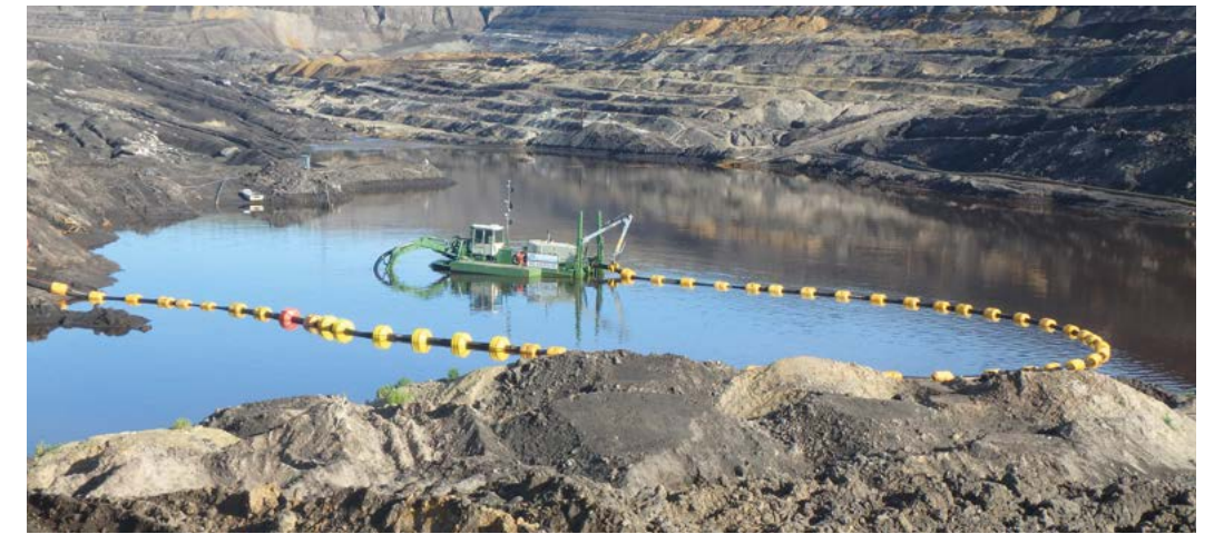
Limpiar y mantener desechos industriales y procesar presas de agua - Watermaster pasa los materiales del agua a la tierra para un posterior tratamiento (imagen de Alemania).
