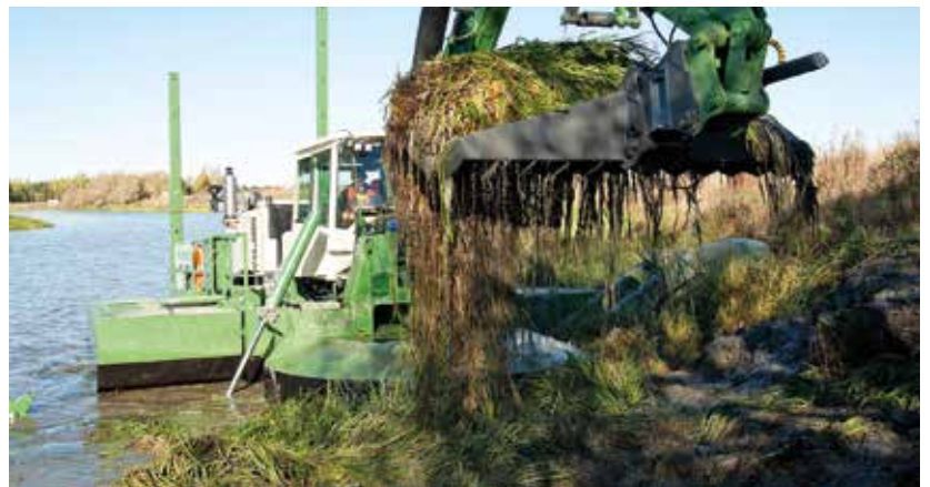
Eliminar la vegetación excesiva: Con su rastrillo, Watermaster elimina la vegetación acuática que flota en el agua y también la enraizada (imagen de Finlandia).
