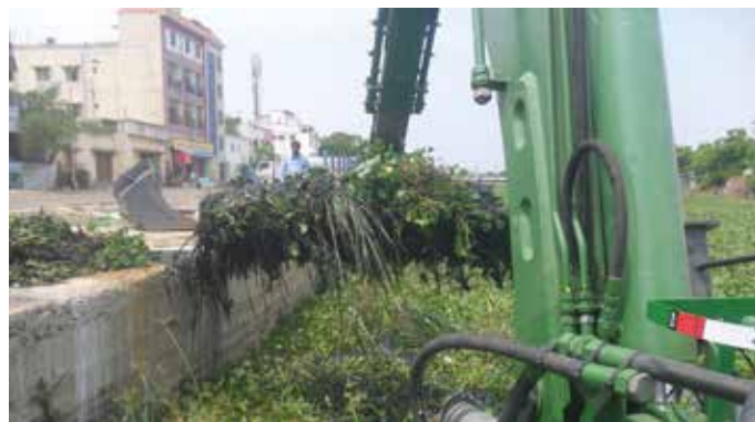
Watermaster rastrilla y quita los sedimentos y la vegetación del canal.
